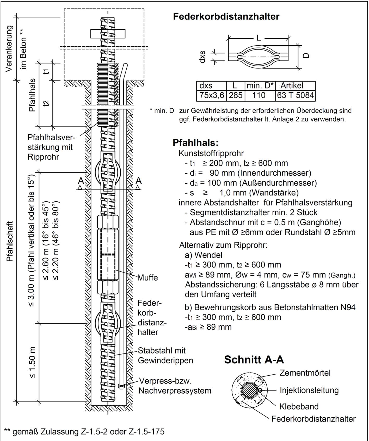
Verbundpfahl System Porr  $d=57,5 \text{ mm}$  und  $d=63,5 \text{ mm}$  mit einem Tragglied aus Stabstahl mit Gewinderippen S 555/700
