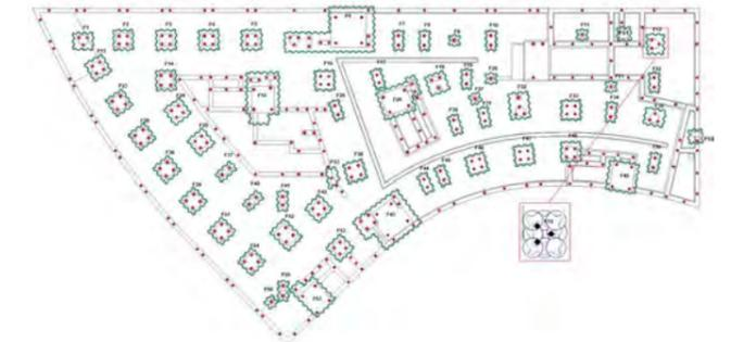
Übersicht der Baugrube mit Spundwand-kästen und Pfahlansatzpunkten © Stump-Franki
