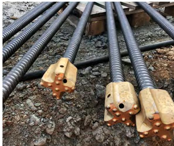
Hohlstab mit Bohrkronen © Stump-Franki
