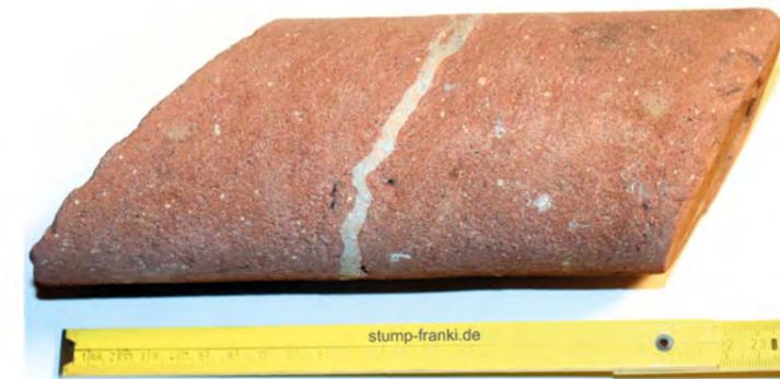
Kernbohrung, Suspensionsgefüllte Kluft im Bundsandstein
