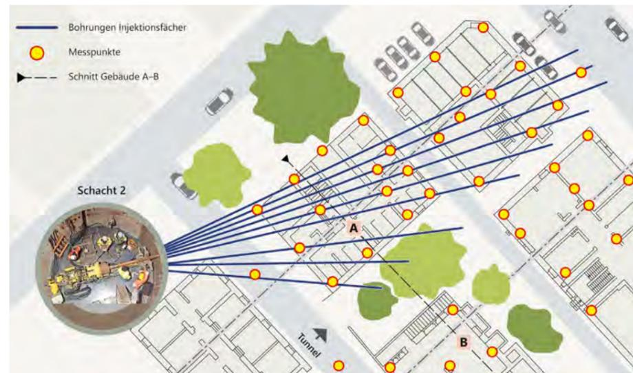
Übersichtplan mit Bohrstreifen und Messpunkten
