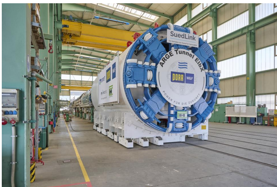
Die für das Projekt entwickelte TBM ist speziell für die wechselnden Bodenverhältnisse unter der Elbe ausgelegt und wird im maschinellen Vortrieb mit Tübbingausbau arbeiten. © TenneT TSO GmbH
